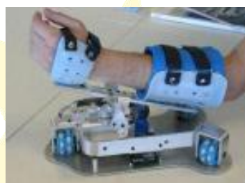
Фиг.5. Опорна система на модула и устройство на Omni wheel колело
